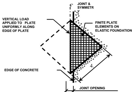
Fig. 3a. COMPUTER MODEL FOR DIAMOND PLATE DOWEL
